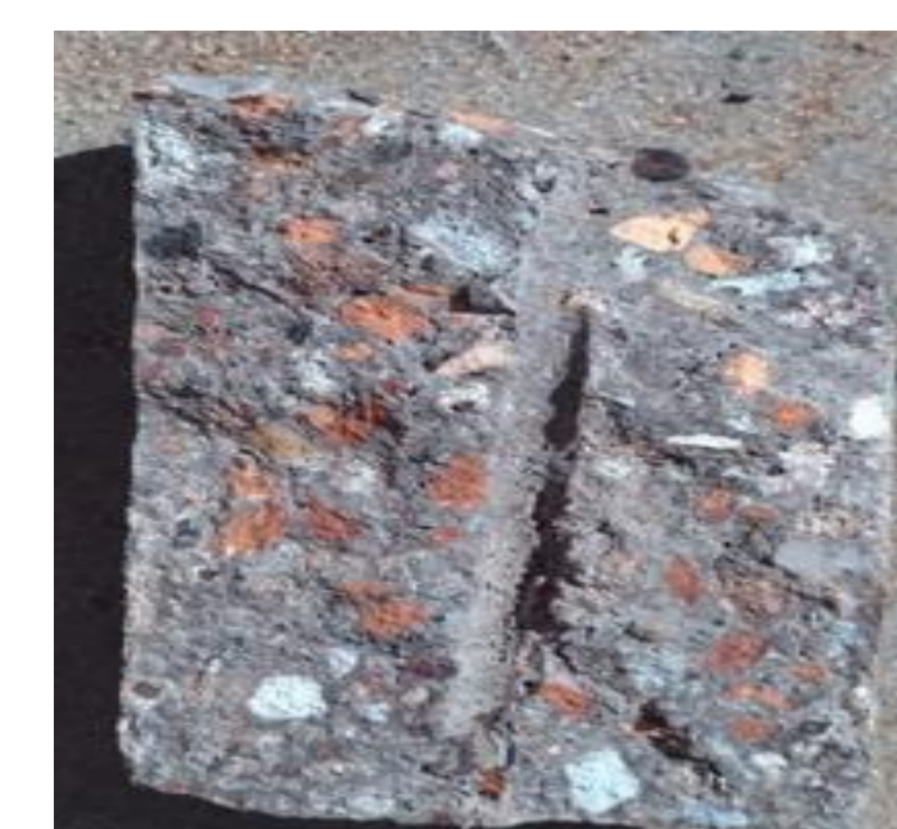
Figura 8: Corpo de prova rompido
