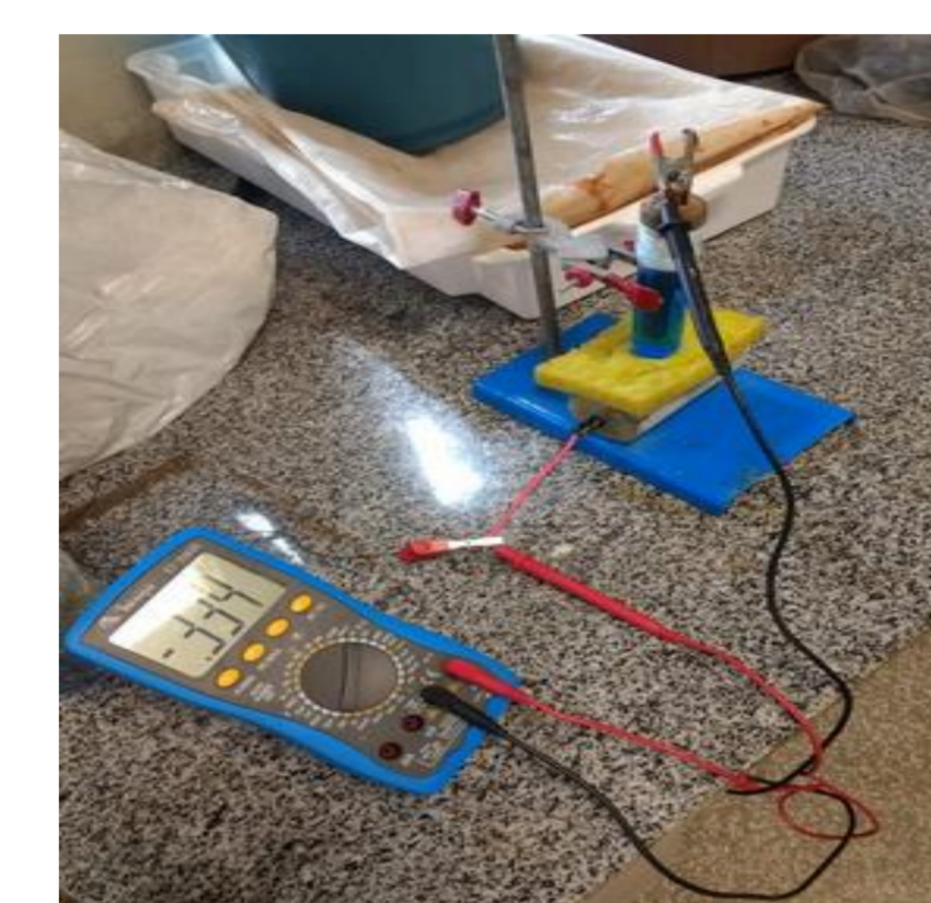
Figura 5: Ensaio de medição do potencial elétrico
